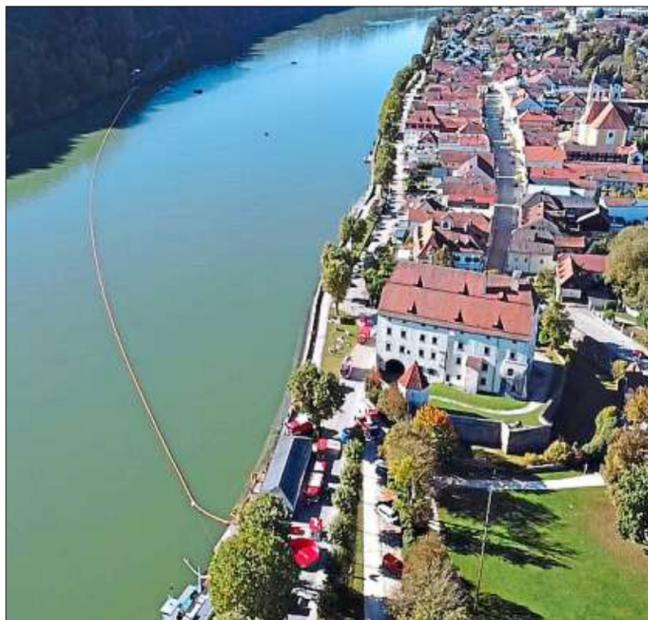
**Die Uferansicht Oberzells im Rücken,** wurden die 500 Meter langen Ölsperren diagonal zum Flussverlauf, Richtung Österreich, bewegt.
